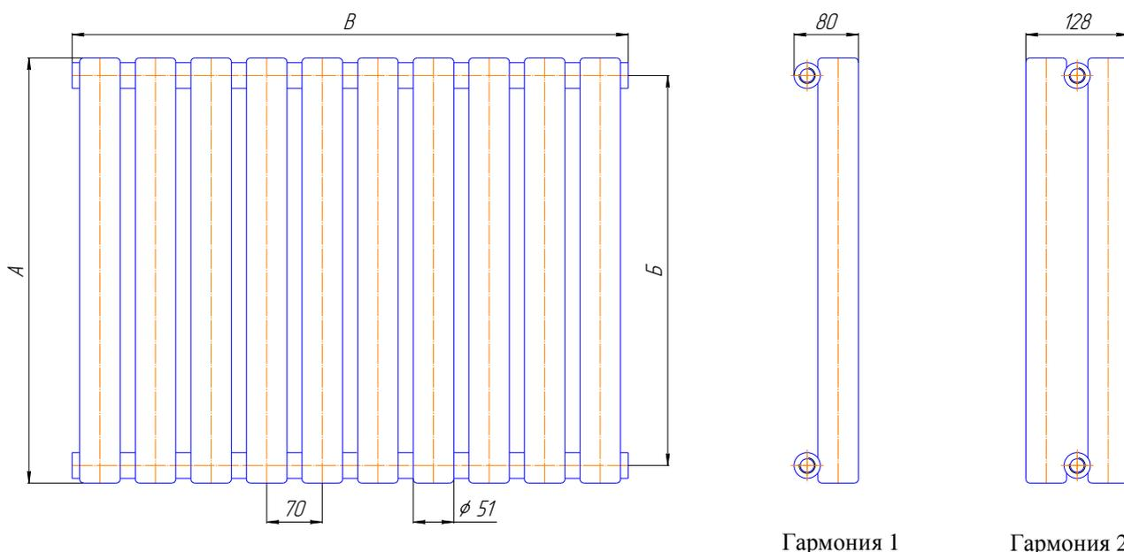
Рис. 2 Конвектор «Гармония».
