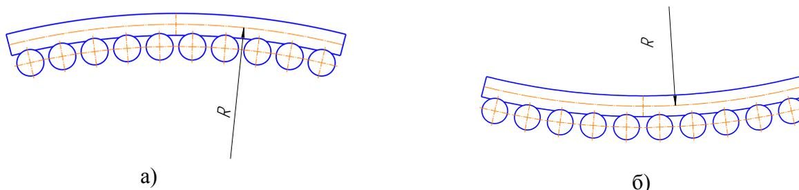
Рис.7 Радиусное исполнение отопительных приборов серии «Гармония» (вид сверху)
